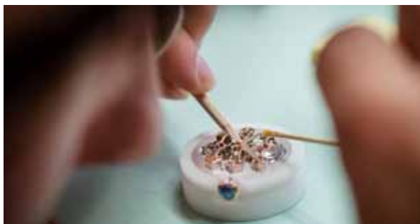
Mise en place des aiguilles
